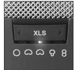
Abb. 1: Wahlschalter für Richtcharakteristiken
