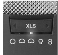
Fig. 1: Conmutador-selector para las características direccionales
