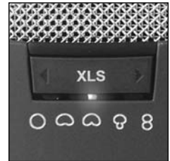
Fig. 1 : Sélecteur de caractéristiques de directivité
